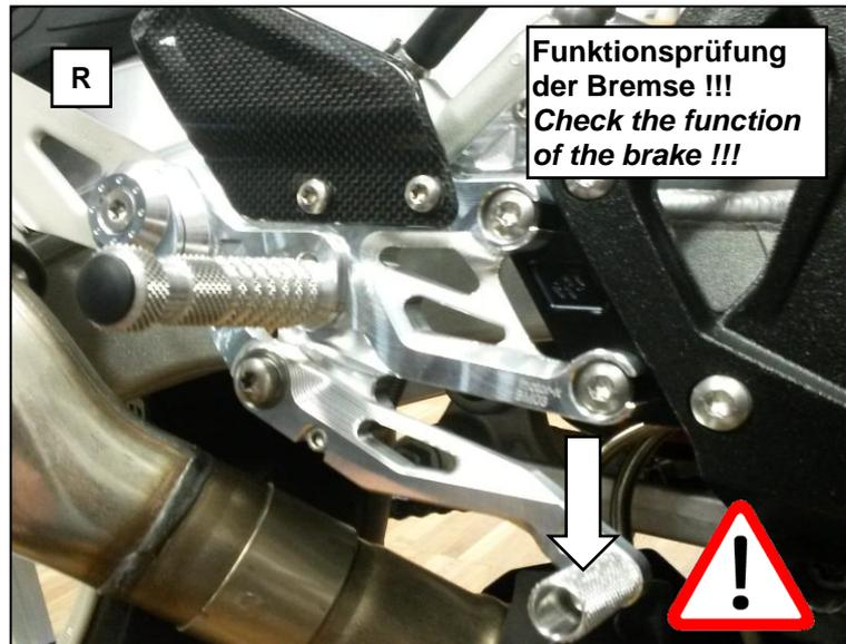
**-Zur Durchführung des folgenden Tests sollte das Hinterrad frei drehbar in der Luft sein!
