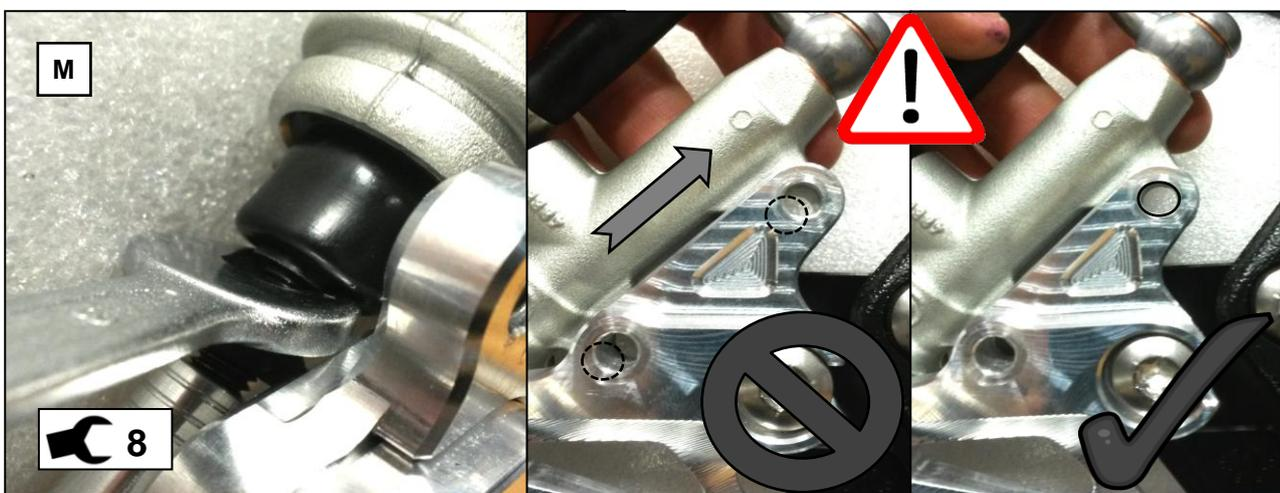
**M:** Drehen Sie die Betätigungsstange (Schlüsselfläche unterhalb der Gummimanschette) des Bremszylinders mittels Maulschlüssel 8mm hinein oder heraus, sodass die Bohrungen des Bremszylinders deckungsgleich mit den Bohrungen der Rastenanlage sind- **Beide in einer Flucht (anderfalls stimmt das Bremsenspiel nicht)**!
