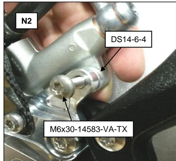
**-Die beiden Schrauben müssen sich aufgrund von Schritt M leichtgängig durch die Bohrungen stecken lassen!**
