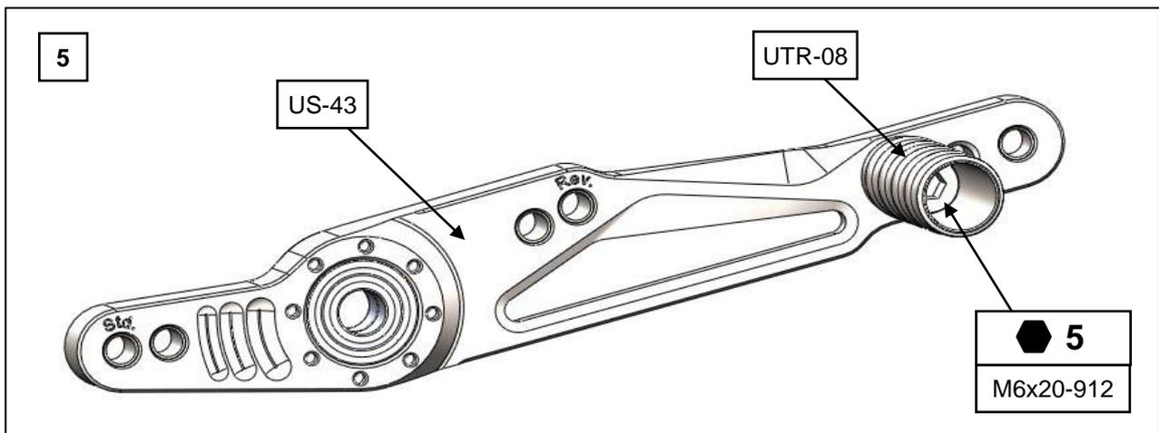
**5:** Schalthebel **US-43** mit den Angaben der Darstellung vormontieren:
