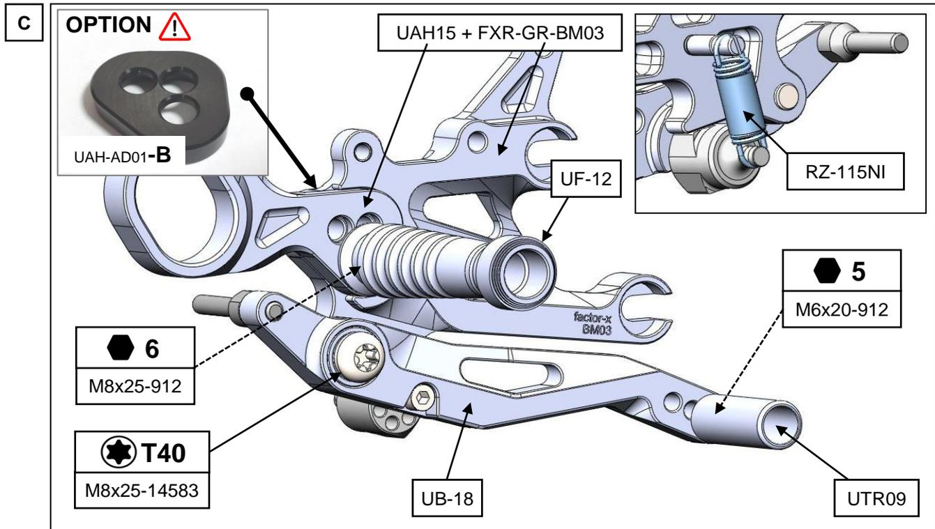
**OPTION:** Sie können optional den Adapter UAH-AD01-B erwerben um den Auspuffhalter UAH15 zu ersetzen! (Anwendung bei Zubehör-Auspuffanlagen welche nicht an der Rastenanlage montiert werden!)
