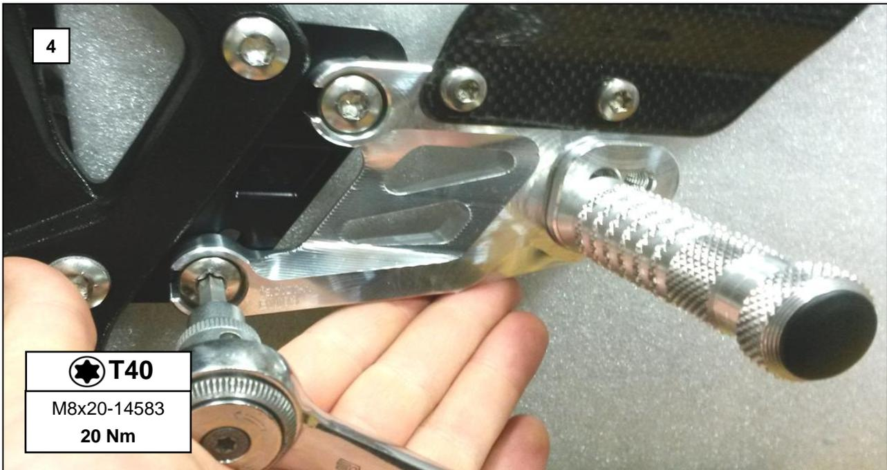
**4:** Setzen Sie die Rastenanlage auf die Zwischenplatte **FXR-HA-BM03** und schrauben Sie diese fest.
