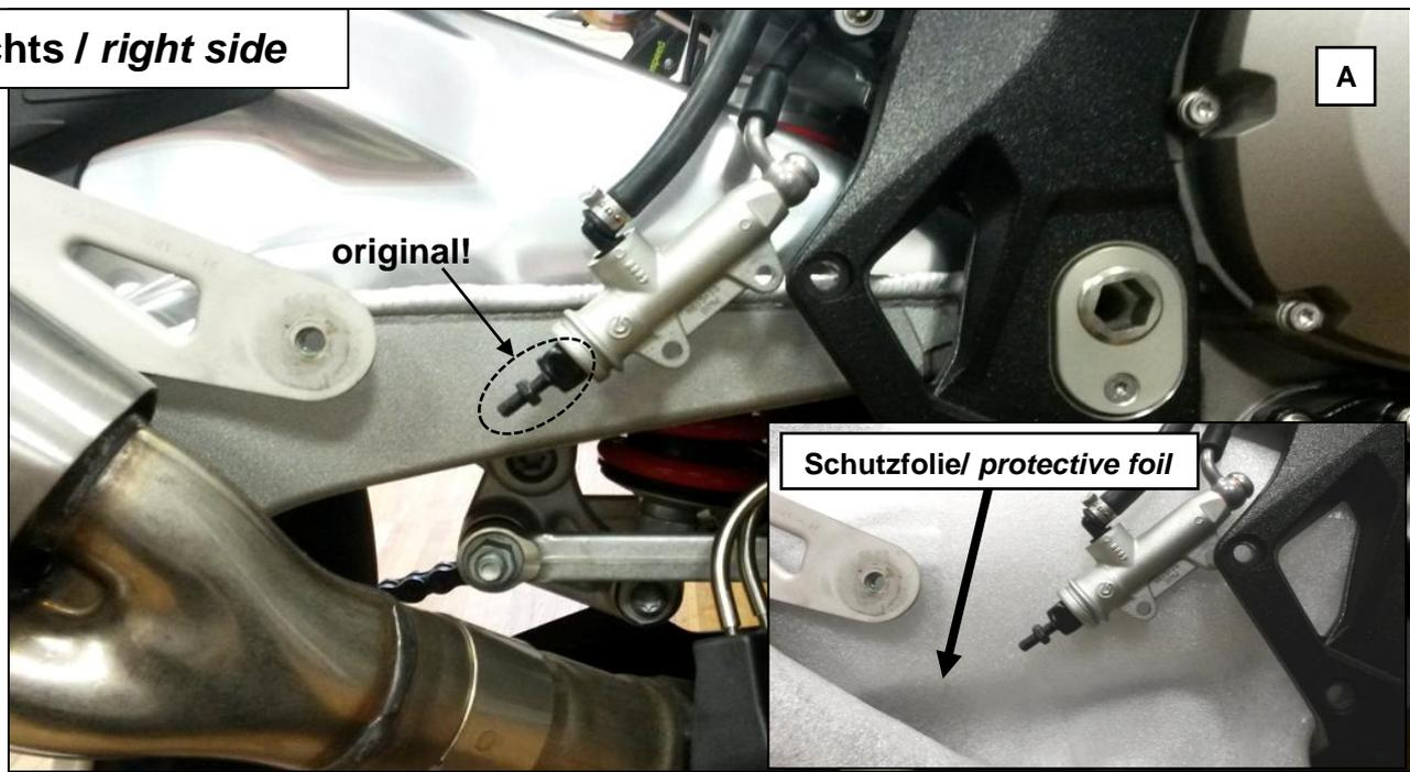
**A:** Originale Rastenanlage demontieren und Auspuff, sowie Schwinge durch Abdecken gegen Beschädigungen schützen.
