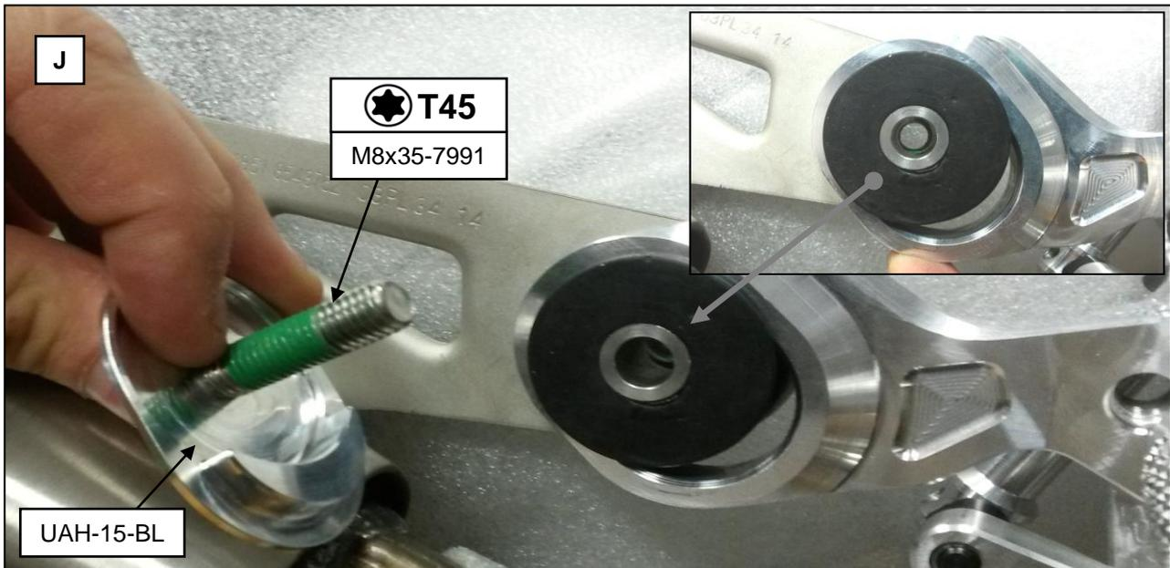
**J:** Verbinden Sie den Auspuff mit dem Auspuffhalter der Rastenanlage. Drücken bzw. ziehen Sie gegebenenfalls den Auspuff oder die Rastenanlage, sodass alle Bauteile am Auspuffhalter fluchten. Montieren Sie die Blende **UAH-15-BL** unter Nutzung der Schraube **M8x35-7991-VA-TX**.
