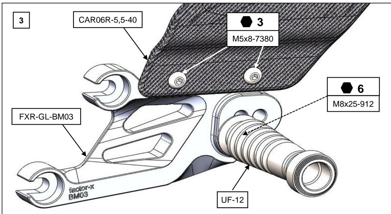
3: Rastenanlage mit den Angaben der Darstellung vormontieren:
