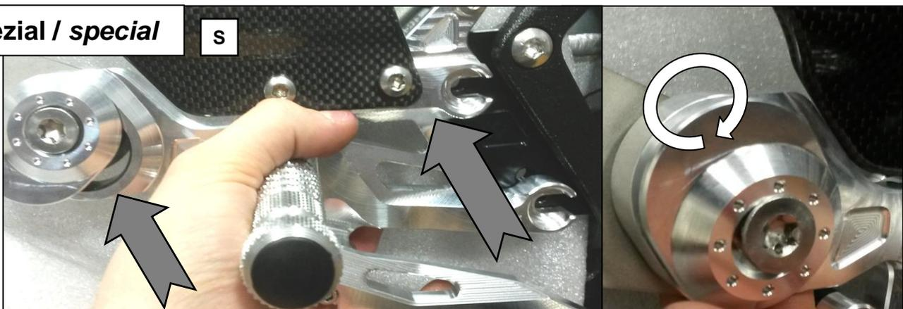
**S:** Die Rastenanlage kann zusätzlich auf der Zwischenplatte **FXR-HA-BM03** in der Höhe versetzt werden. Dazu ist die Verbindung am Auspuffhalter un der Grundplatte zu öffnen. Die Blende **UAH-15-BL** ist durch Verdrehen an den entsprechenden Anbauzustand anzupassen. (Drehmomente in Schritt K)
