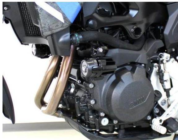
Linker und rechter Halter (in Fahrtrichtung) für Zusatzscheinwerfer. Montage am Motorgehäuse unterhalb des Kühlers.
