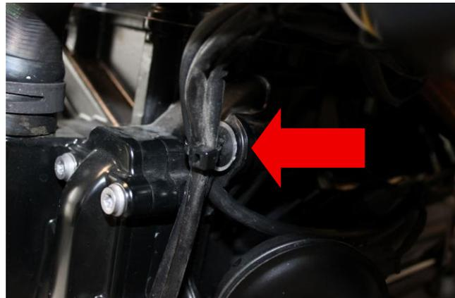
Linke Anbauposition: in das offene M8 Gewinde. Auf der rechten Seite den Kabelbinderstopfen aus dem Gewinde entfernen und den Halter dort befestigen. Die Kabel dann am freien Loch des rechten Halters befestigen.
